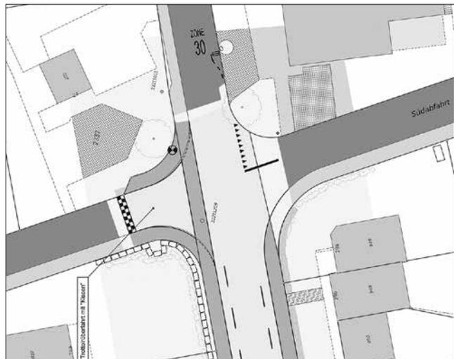
Die Einmündung der Scheidwegstrasse wird mit einer Trottoirüberfahrt mit «Kissen» ausgestattet und die Einmündung der Südabfahrt mit einer Haifischzahn-Markierung (kein Vortritt) versehen. Vortrittberechtigt sind wie heute die Verkehrsteilnehmer auf der Stationsstrasse. So wird verhindert, dass auf der Stationsstrasse geradeaus ins Dorfzentrum fahrenden Radfahrern und Fahrzeugen die Weiterfahrt durch von der Südumfahrung her einmündende Fahrzeuge abgeschnitten wird.
