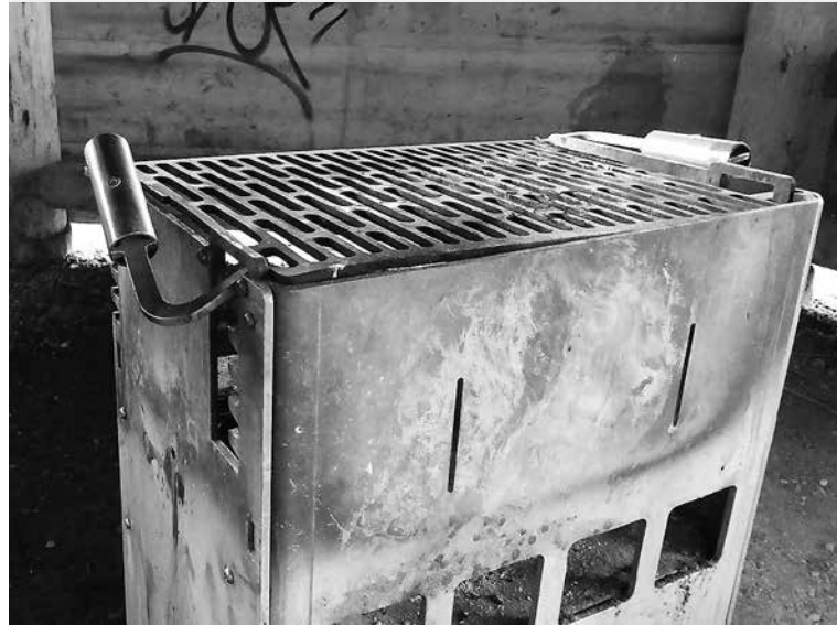
Schadensbild: abgebogener Griff und verbogener Grillrost
